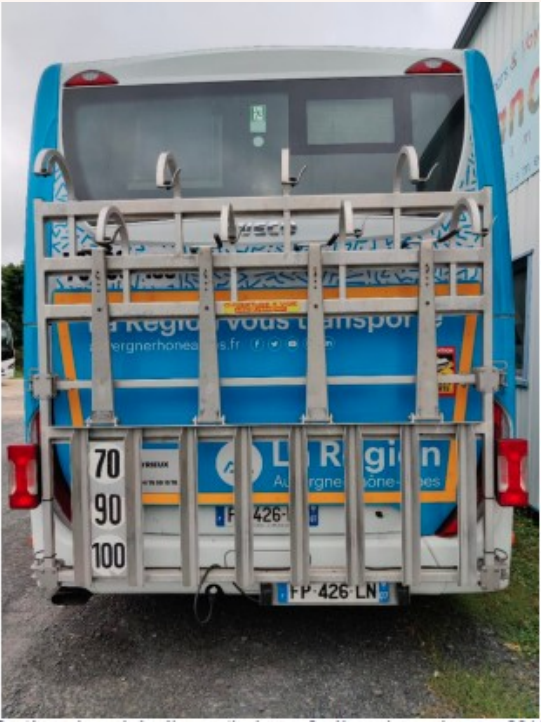
Source Galéo - système de rack à vélos vertical pour 8 vélos -
